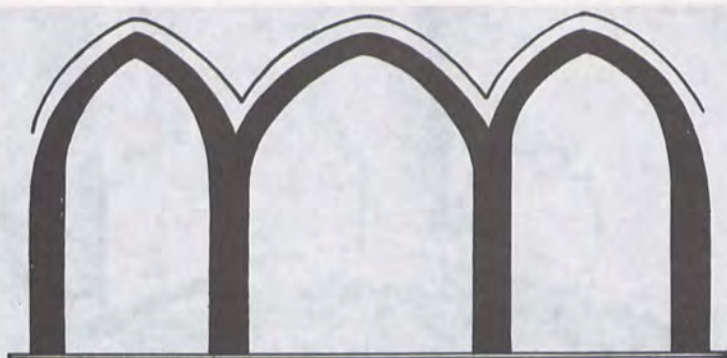
48. Przekrój pionowy kościoła Św. Marcina. Skala 1 cm - 3,5 m
