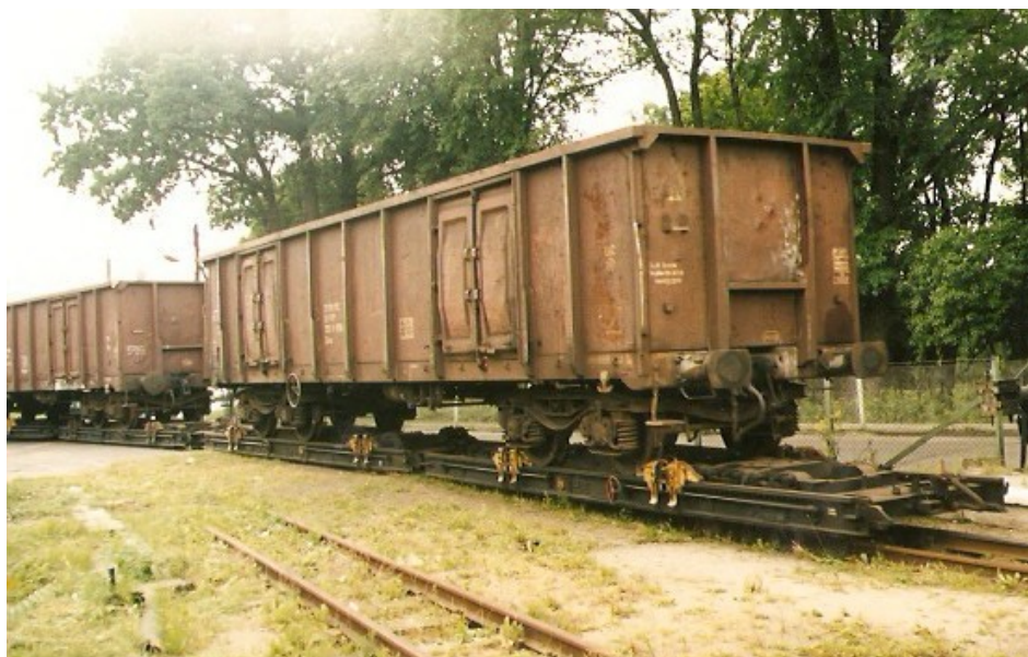
II. 3. Węglarki czteroosiowe na "rollbockach" (transporterach). Śmigiełska Kolej Wąskotorowa. 17 lipiec 1998 rok. Fot. Henryk Magoń
