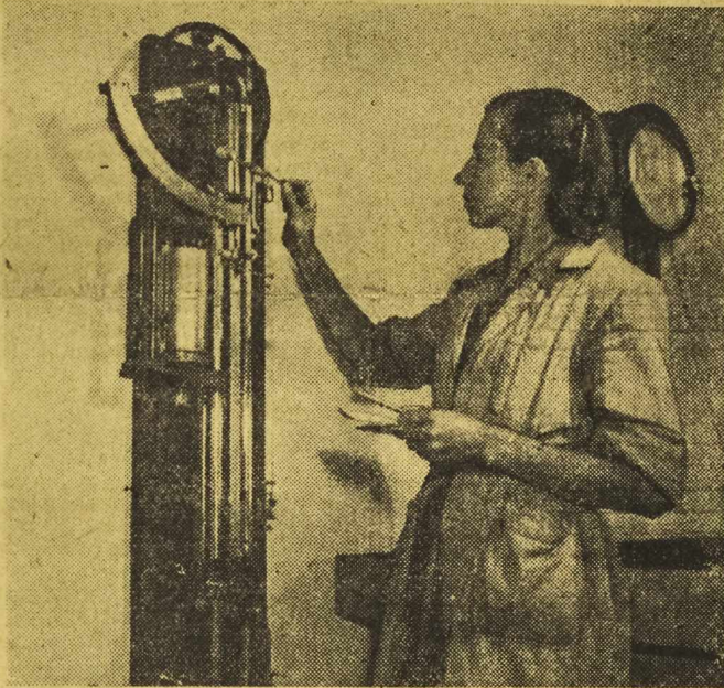
Na zdjęciu: w laboratorium włókienniczym fabryki Helena Strzałkowska bada wytrzymałość wyprodukowanego sztucznego włókna.
