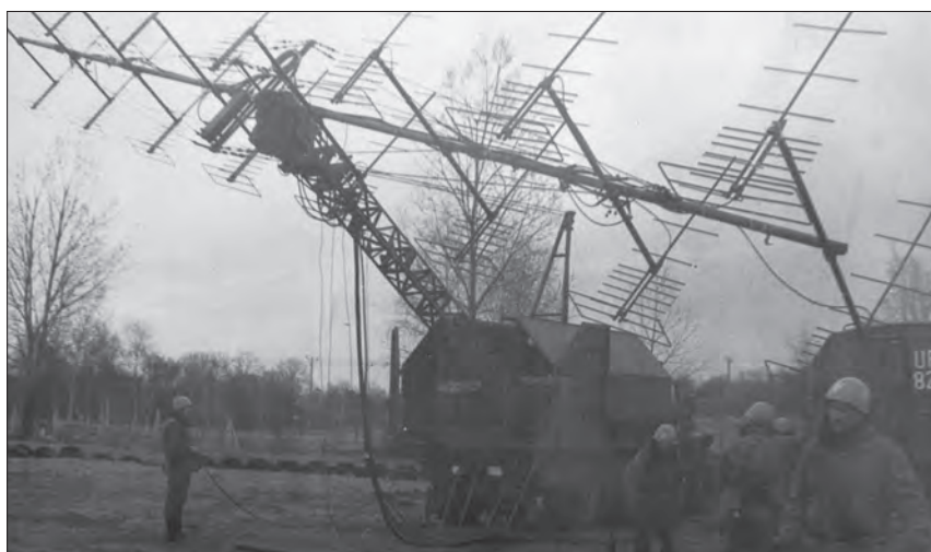
Fot. 6.89. Podnoszenie anteny stacji P-18
