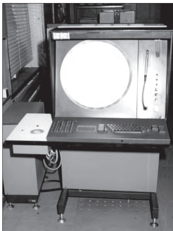
| Fot. 8.51. Konsola graficzna operatora obiektu CYBER-W
