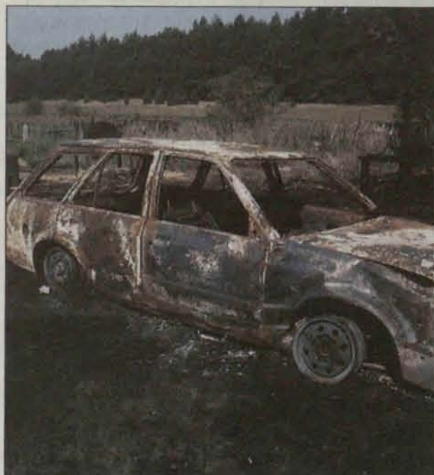
Efekt zwarcia instalacji elektrycznej w samochodzie
