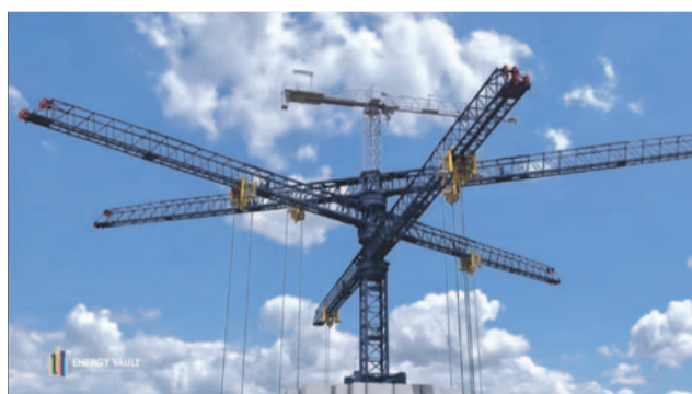
Skomplikowany system ramion pozwoli symetrycznie wciągać lub opuszczać ciężkie bloki, magazynując lub uwalniając zieloną energię
