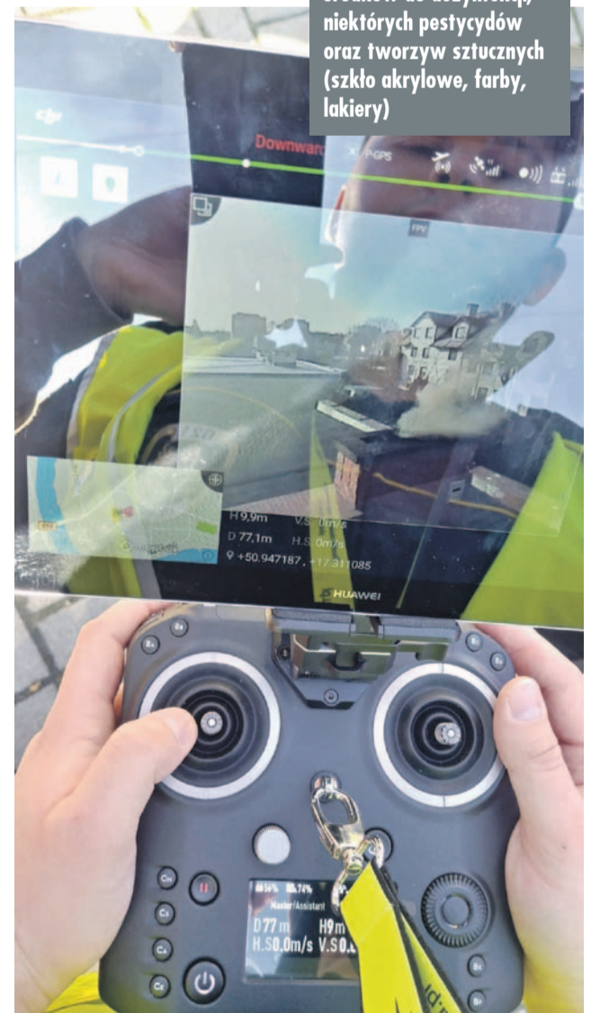
Tak wygląda pad do sterowania dronem. Do niego przymocowany jest tablet, który pokazuje obraz z kamery umieszczonej na dronie
