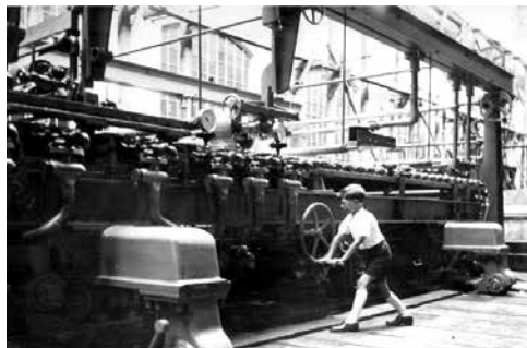
Ryc. 21. Na przełomie roku 1924/25 zostały wykonane pierwsze maszyny papiernicze o szerokości 6 m (5 m szerokość obcięcia) – po jednej dla Szwecji i dla Anglii
