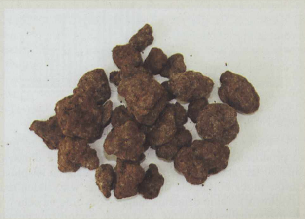
Osad ściekowy wysuszony w suszarni słonecznej
