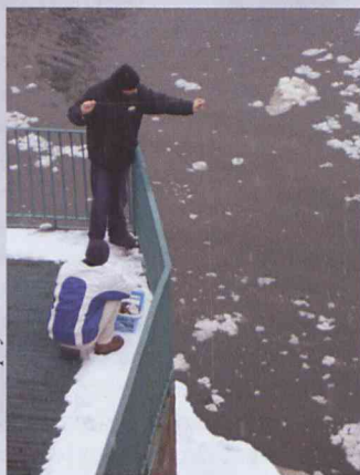
Miejsce pobory próbek wody przy Jazie Opatowickim, pomiar przezroczystości Krążkiem Secchi'ego. Bez względu na pogodę.
