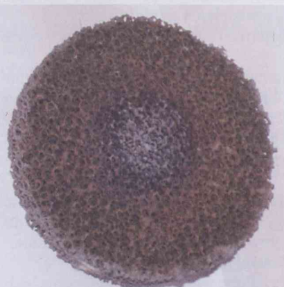
Rys. 5. Filtr do wstępnego usuwania sadzy emitowanej z autobusu miejskiego typu Ikarus (w środkowej części widoczne efekty wypalenia sadzy).
