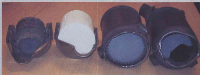
Rys. 4. Zdjęcie katalizatorów do oczyszczania spalin silnikowych, świeżych (zdjęcia wewnętrzne) i poddanych erozji termicznej (zewnętrzne).
