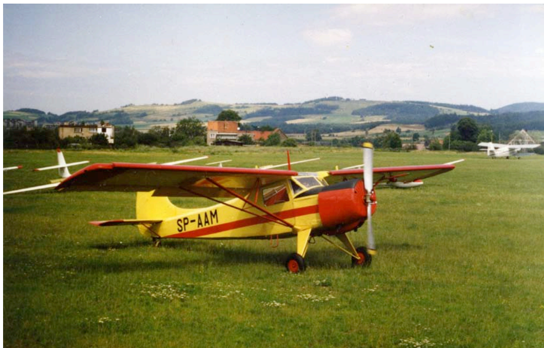
Ryc. 23. Samolot JAK-12M holujący szybowce. Lotnisko Jelenia Góra (źródło: Józef Puszczynski)
