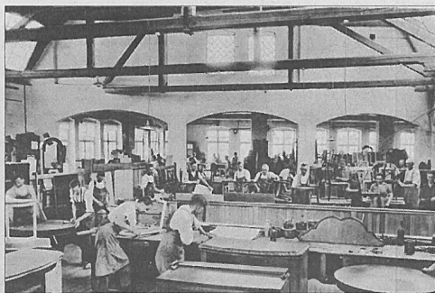
6. Kompletowanie rozkładanych stołów, w głębi montownia krzeseł
