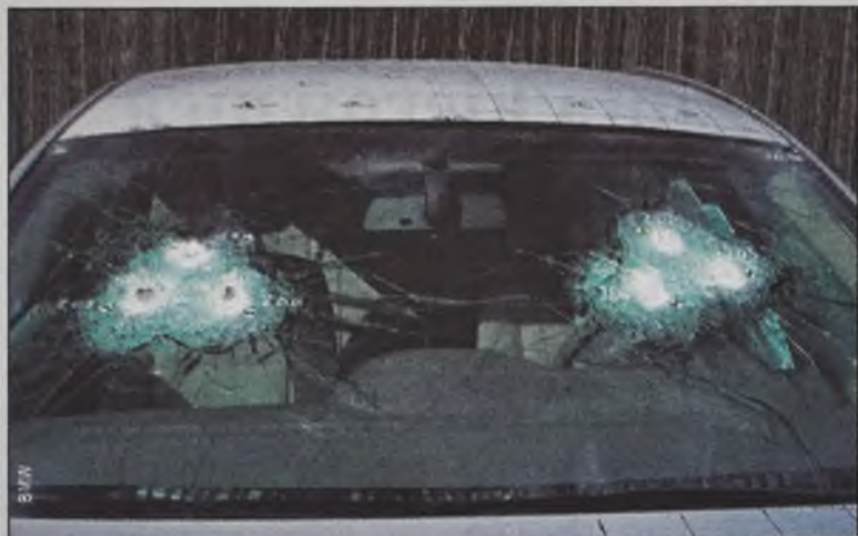
Próby z użyciem broni palnej (BMW serii 7) na szybie czołowej
