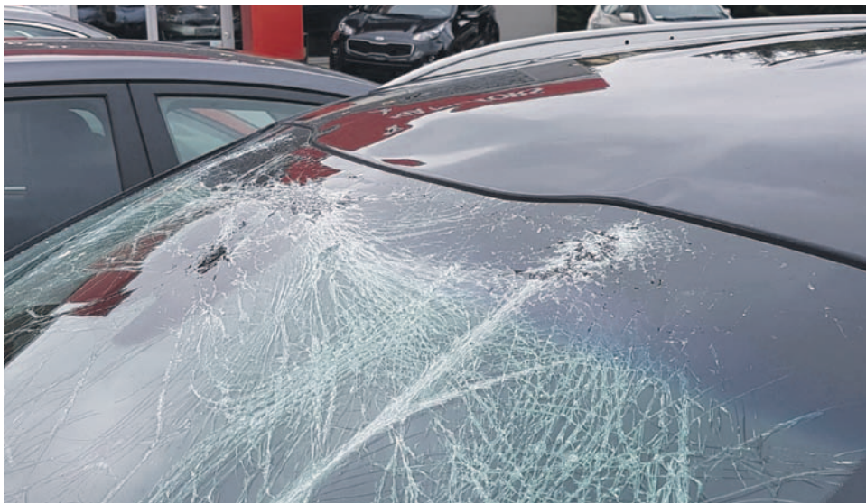
Zerwana podczas jazdy maska uderzyła w przednią szybę nowiutkiego auta
