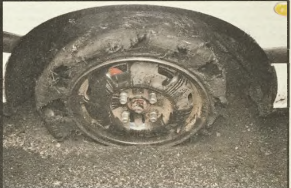
...opona wtopiła się w asfalt
