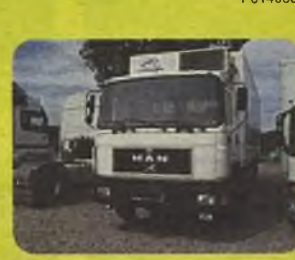
MAN 19.272, 1993 r. chłodnia, Euro II, Pakiet L, 270 KM, 2 osie, zawieszania pneumatyczne, ABS, kabina komfortowa, hak holowniczy, ład. 6 t, agregat do -15 stopni C. P6070292
