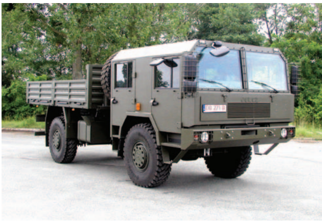
Jeden z produktów spółki „Jelcz-Komponenty”, Jelcz 442.28 z opancerzoną kabiną załogową
