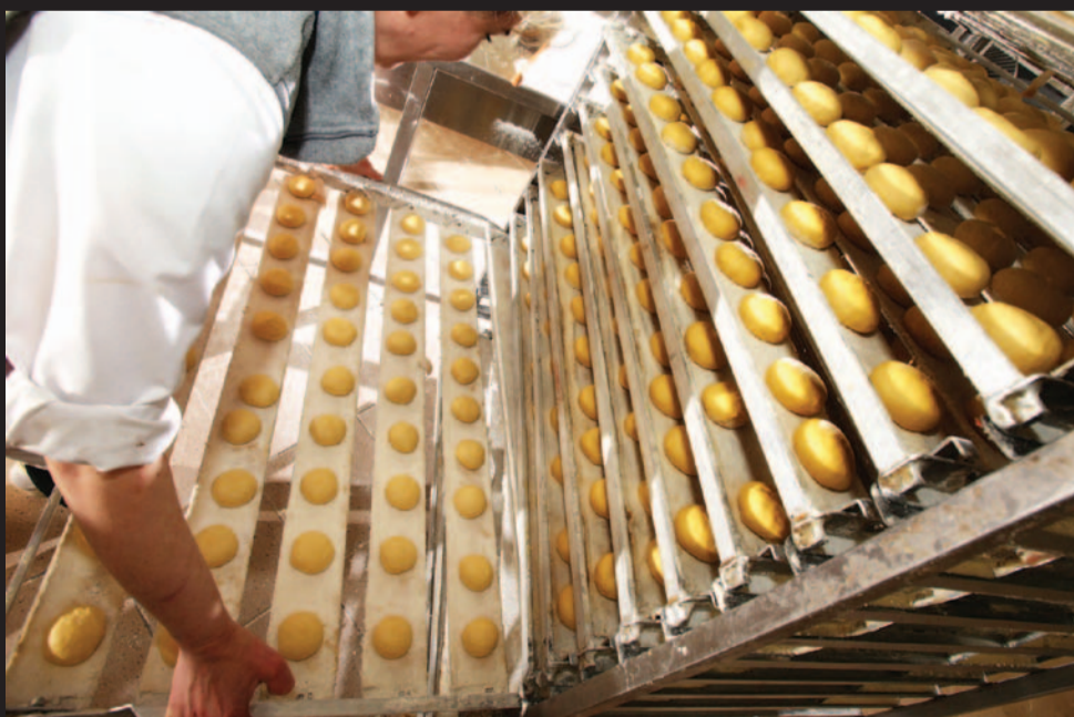
Po uformowaniu tysiąca kulek małe pączki trafiają do garownika, gdzie przez 40 minut rosną do właściwych rozmiarów
