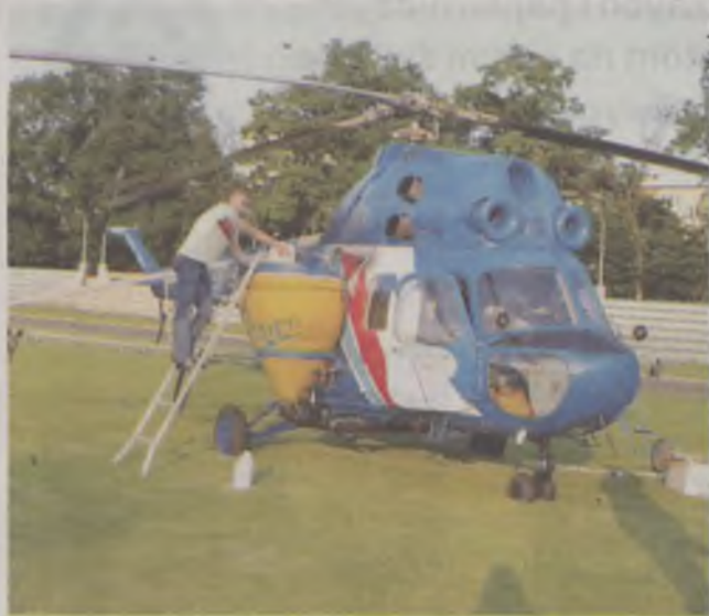
Przygotowanie śmigłowca do oprysków
