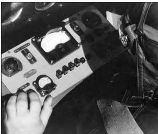
Aparatura trzykanałowa zapewniała pomiar intensywności pola gamma, pola magnetycznego i wysokości lotu (1)
