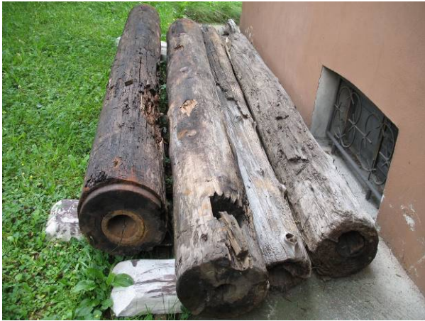
Wasserleitungsrohre aus hohl- gebohrten Baumstämmen, Deicheln genannt
